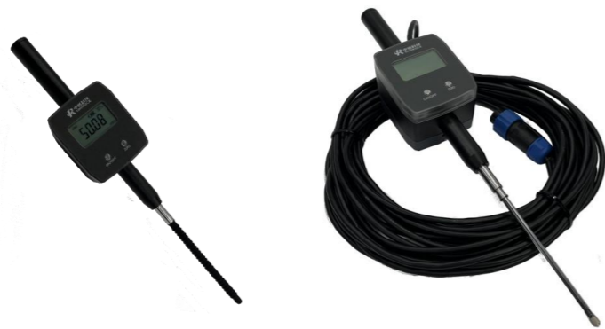
图2-1 (c) RSM-JC6(E)无线 (左) 和有线 (右) 位移传感器
