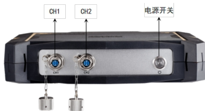
图2-2 桥梁孔道灌浆质量检测仪侧面
