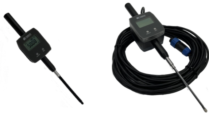
图2-1 (c) RSM-JC6(C)无线 (左) 和有线 (右) 位移传感器
