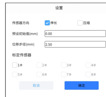
图3-5(c) 数字位移传感器标定设置界面图
