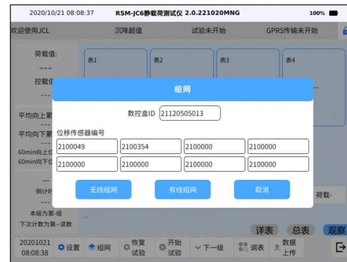
图3-3(1) 试验采集-组网界面图
