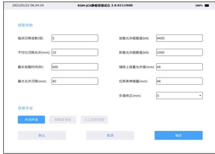
图5-3(q) 试验采集-报警设置图
