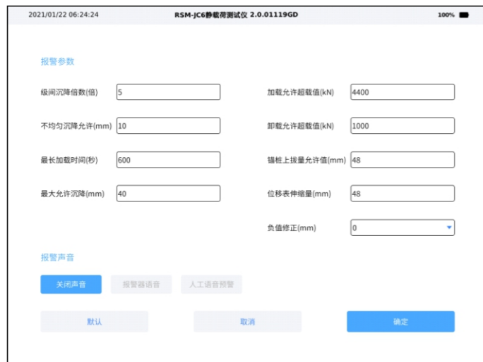
图6-3(s) 试验采集-报警设置图
