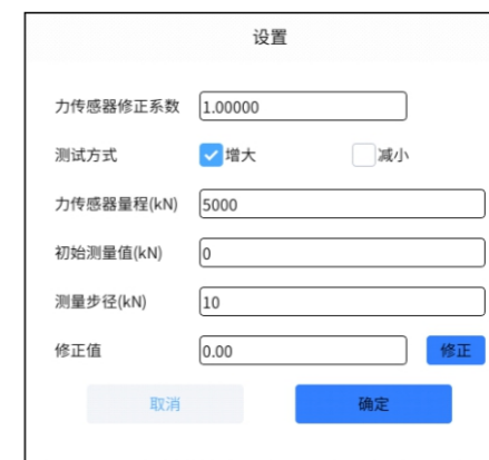
图3-5(i) 荷重传感器标定设置界面图
