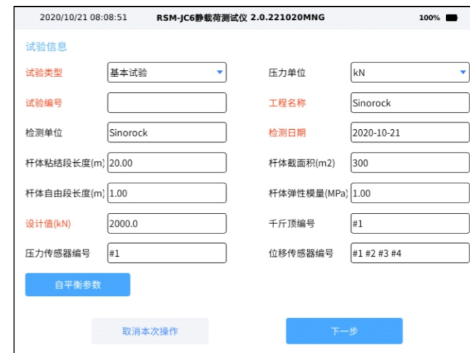
图3-3(5) 试验引导-锚杆荷载试验信息设置界面图
