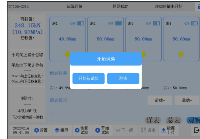
图5-3(f) 试验采集-开始新试验选择图
