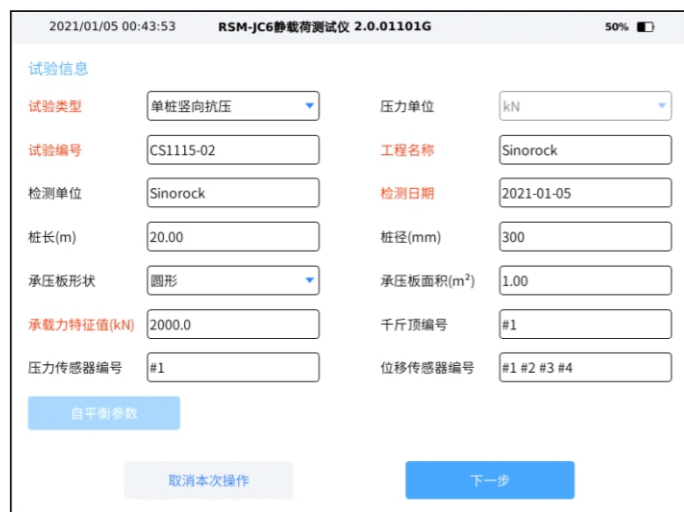
图3-3(4) 试验引导-桩和地基试验信息设置界面图
