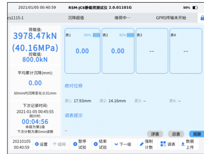
图3-3(26) 试验采集-观察界面图
