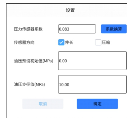
图3-5(f) 压力传感器标定设置界面图
