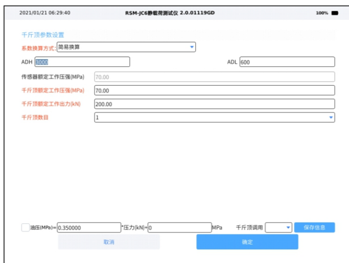
图3-5(g) 压力传感器标定系数换算界面图
