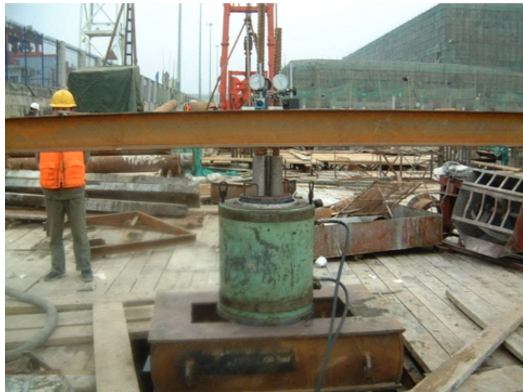
图6-2(a) 现场反力平台图
