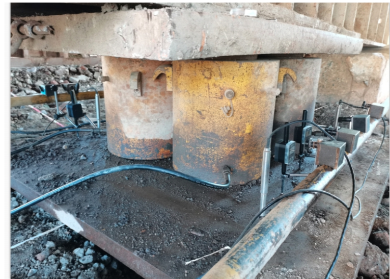
图5-2(d) 现场位移传感安装图（图中为比对试验传感器安装图）
