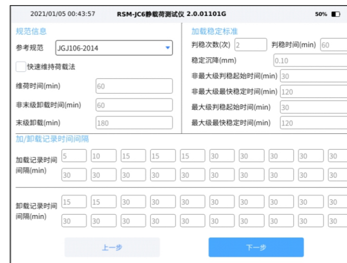
图5-3(h) 试验采集-试验规范设置图
