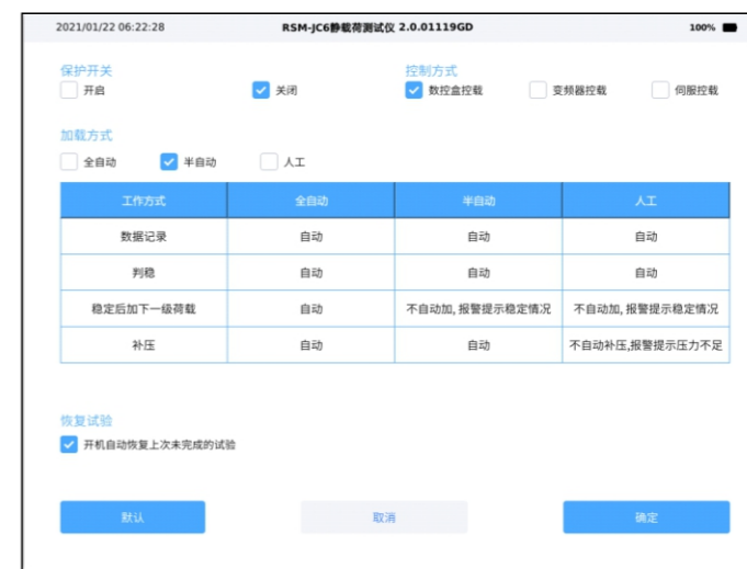
图3-3(17) 设置-基本设置操作栏界面图
