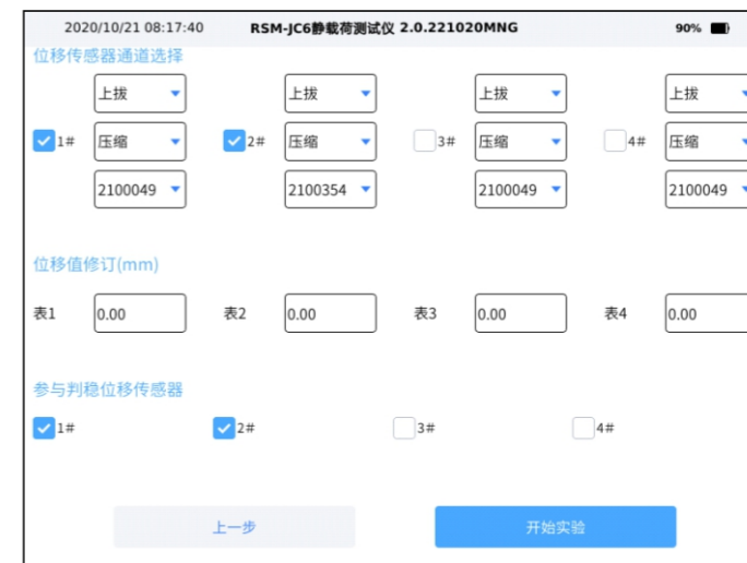
图3-3(13) 锚杆荷载试验引导-位移传感器设置界面图
