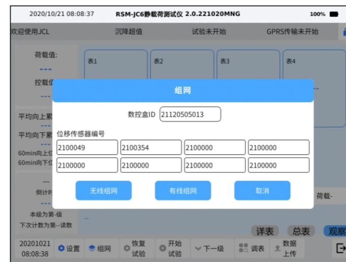
图3-3(1) 试验采集-组网界面图
