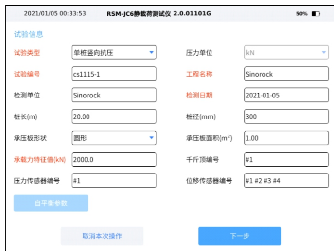
图5-3(g) 试验采集-试验信息设置图
