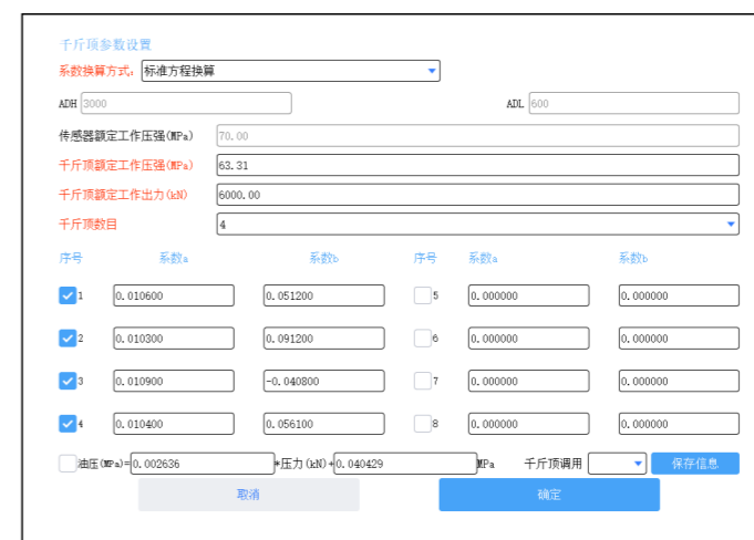
图5-3(i) 试验采集-千斤顶率定参数设置图
