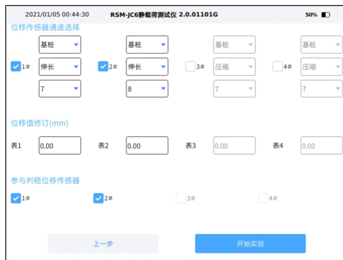
图3-3(12) 桩和地基试验引导-位移传感器设置界面图
