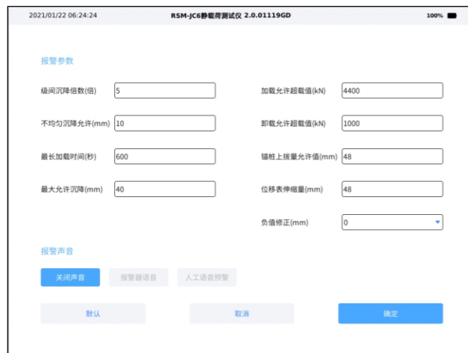
图3-3(18) 设置-报警参数设置操作栏界面图
