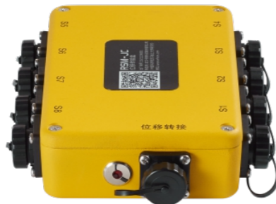
图2-1 (e) RSM-JC位移转接盒 (有线位移传感器配备)
