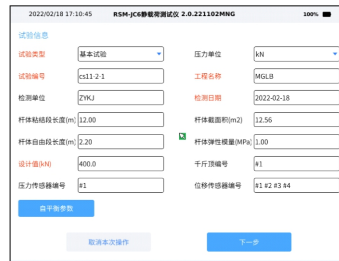
图6-3(g) 试验采集-试验信息设置图
