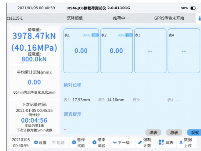
图3-3(26) 试验采集-观察界面图
