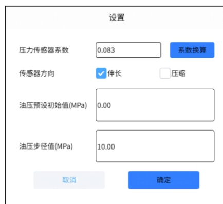
图3-5(f) 压力传感器标定设置界面图
