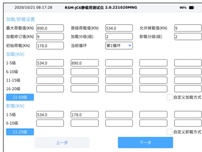
图3-3(11) 锚杆荷载试验引导-加载/卸载设置界面图
