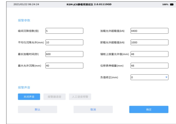
图5-3(q) 试验采集-报警设置图
