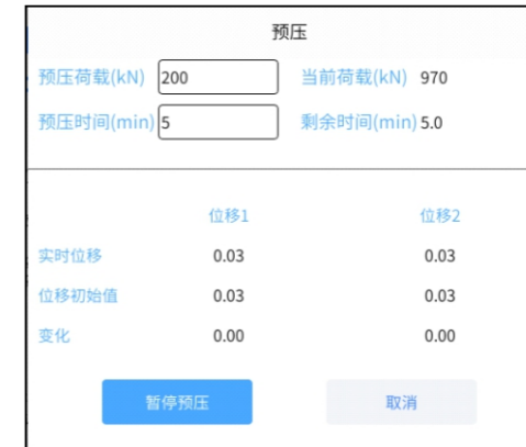
图3-3(14) 试验引导-预压设置界面图
