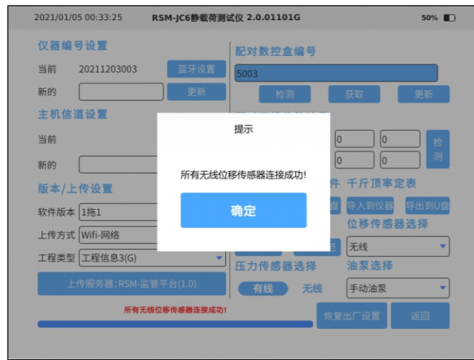
图5-3(b) 软件设置-数控盒录入配对连接图
