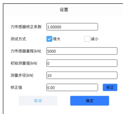
图3-5(i) 荷重传感器标定设置界面图
