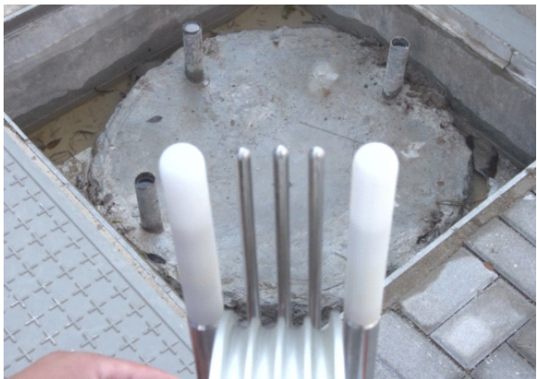
深度计数器安装位置示意图
