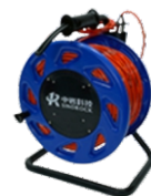
双发双收 跨孔换能器
