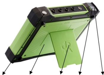
电源开关 可拆卸电池 支架 USB 接口 外接电源
