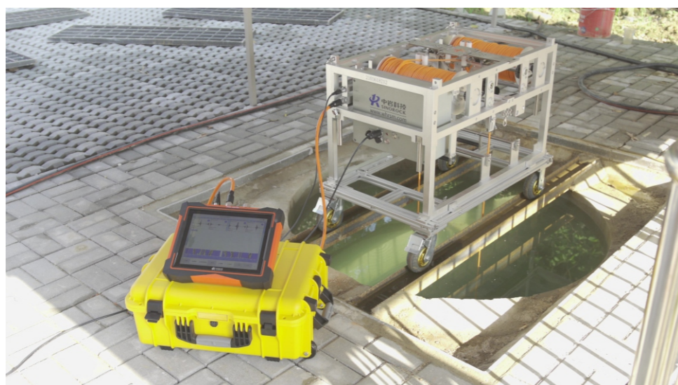
图4-4 超声波成孔检测现场检测示意图
