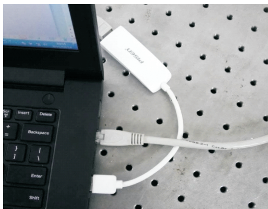
图3-3 相机网线与笔记本连接示意图
